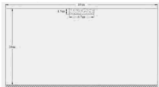
شکل ۳- نمایش عمق و عرض فنداسیون و خاک پیرامون آن
