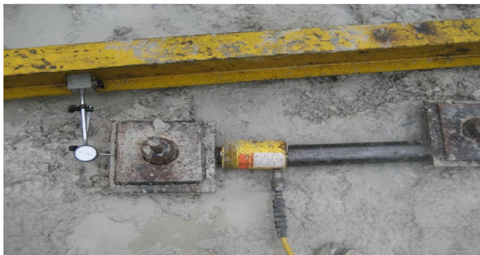
شکل ۱- اعمال بارگذاری جانبی از طریق عملیات جکینگ در آزمایش مقیاس واقعی [۶]
